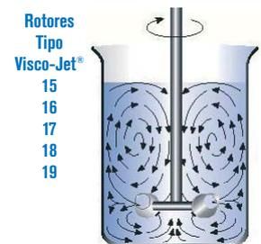
**Flujo Radial Dinámico**, incidencia gráfica del principio cónico en el medio de agitación. Agrupa toda la serie de rotores Visco-Jet®. Excelentes resultados y de mínimo consumo.
