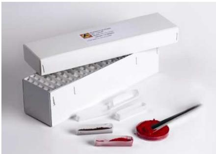
Pequeños recipientes de papel pergamino preparados para la pesada de sustancias viscosas o pastosas antes de la determinación de nitrógeno según el método Kjeldahl.
