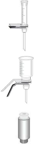
Dos embudos de vidrio para análisis de partículas y recuento de colonias (el de 30 ml se utiliza para test de hibridación). El embudo y la placa porosa de ambos están unidas por una pinza metálica. La frita de vidrio garantiza una distribución uniforme en la retención de microorganismos y partículas en la superficie del filtro.
