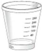
Los embudos Biosart® 250 están fabricados para su uso en microbiología y en la industria. El embudo de plástico de 250 ml de capacidad garantiza una rápida filtración y un elevado rendimiento en los análisis de rutina. Su elevado diámetro interior permite un buen caudal de flujo y la forma cónica de las paredes permiten un cómodo lavado del embudo después del proceso de filtración
